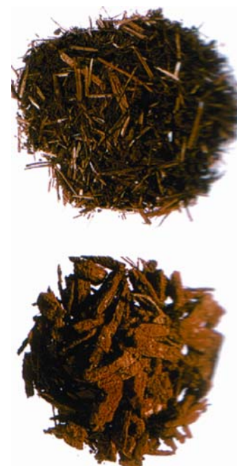
Slika 2. Drvne strugotine kao sredstvo za postizanje poroznosti
