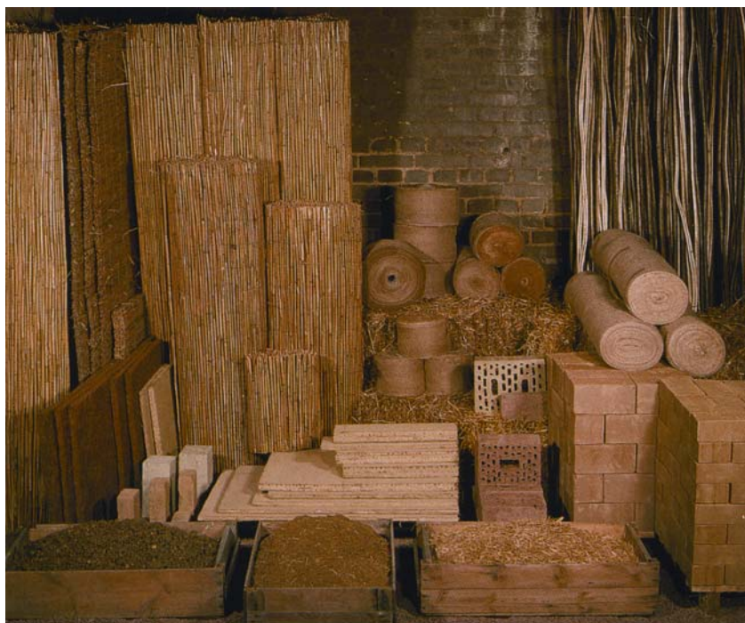
Slika 3. Sredstva za postizanje poroznosti: piljevina, strugotina, ostali drvni ostaci, mljevena ili sjeckana slama
