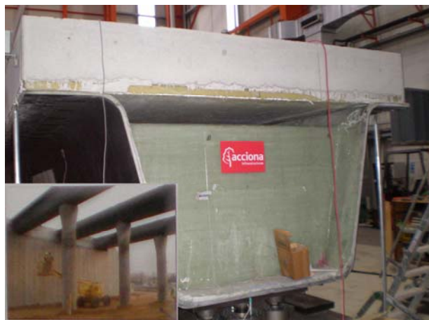
Slika 4. Rebro grednog mosta izvedeno kombinacijom ugljičnih vlakana i laganog betona
