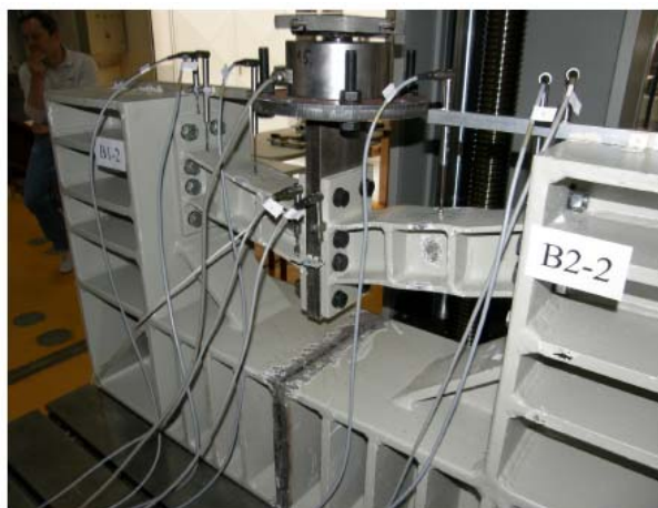
Slika 6. Ispitivanje seizmičkih spona na pomoćnoj konstrukciji
