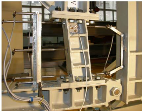
Slika 9. Uzorak s tri para ukruta tijekom ispitivanja
