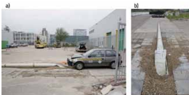
Slika 17. Pokusni sudar pri brzini 35 km/h [9]; a) stup i vozilo nakon sudara, b) stup nakon sudara - stup je zaustavio vozilo
