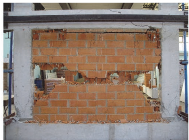
Slika 6. Oštećenje zidane ispune izvedene od šupljih glinenih zidnih elemenata (uzorci O1_bpm i O3_bpm )
