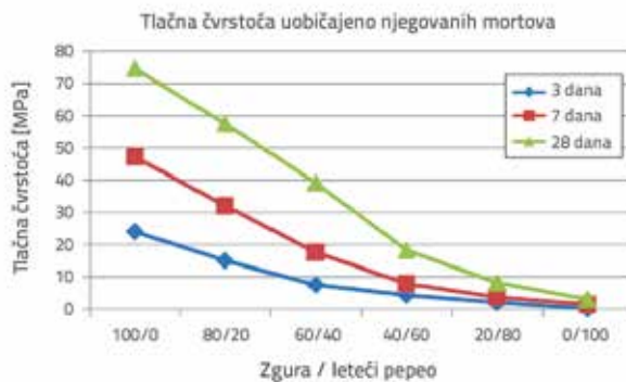
Slika 2. Promjena vrijednosti tlačne čvrstoće ovisno o odnosu zgre i letećeg pepela, za njegu pri sobnoj temperaturi
