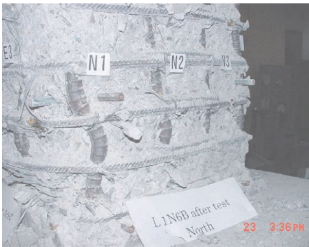
Slika 13. Širenje poprečne armature i odlamanje betona na uglovima stupa [17, 18]
