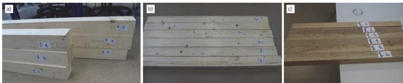
Slika 1. Uzorci od mekog drva smreke i tvrdog drva hrasta grupirani u setove za faze testiranja od 1 do 4: a) smrekove grede, prvi set uzoraka; b) smrekove grede, treći set uzoraka; c) hrastove gredice, drugi set uzoraka
