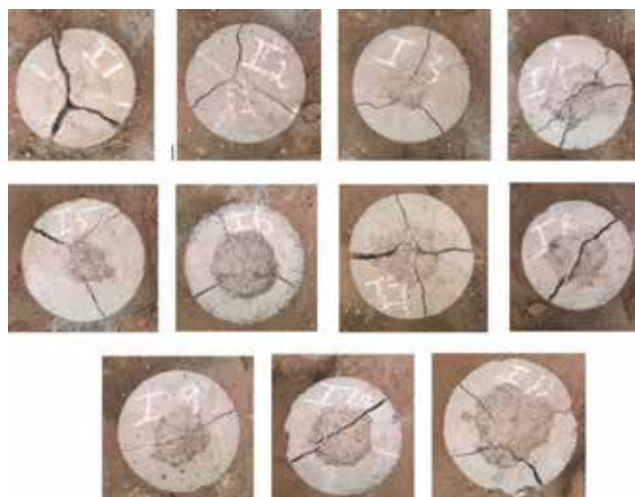
Slika 12. Obrazac pojave pukotina na betonskim uzorcima
