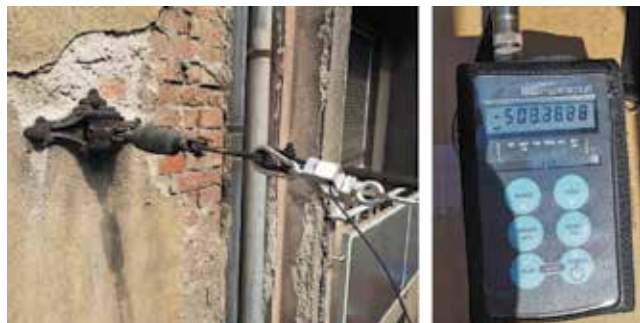
Slika 18. Sustav za mjerenje i očitavanje sile (N)
