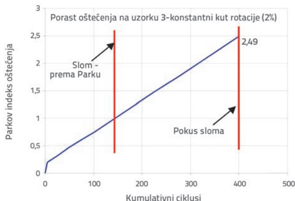
Slika 8. Napredovanje oštećenja uzorka br. 3
