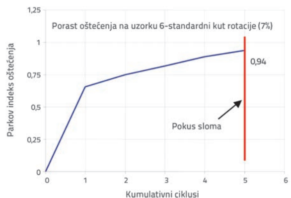
Slika 7. Napredovanje oštećenja na uzorku br. 6
