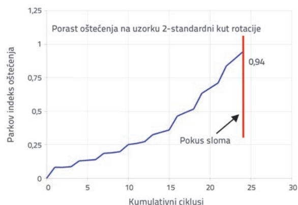
Slika 5. Napredovanje oštećenja na uzorku br. 2
