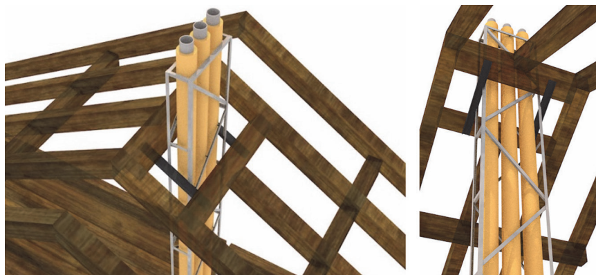
Skica izvedbe konstrukcije dimnjaka čeličnim profilima
