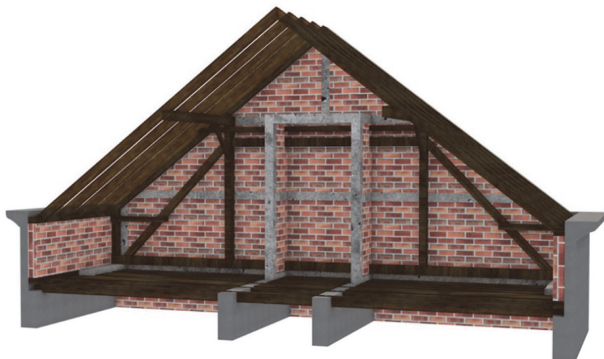
Stabilizacija peterokutne lastavice većih raspona izvedbom zidanih kontrafora
