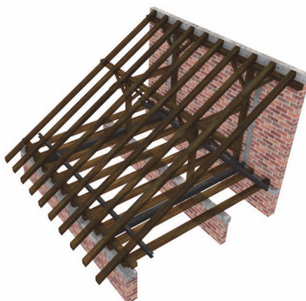
Stabilizacija tavanskih zidova čeličnim profilima
