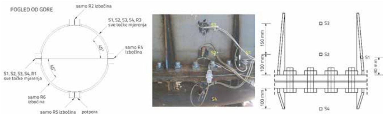
Slika 3. Položaj tenzometara – obodni položaj (lijevo) i vertikalni položaj (desno)
