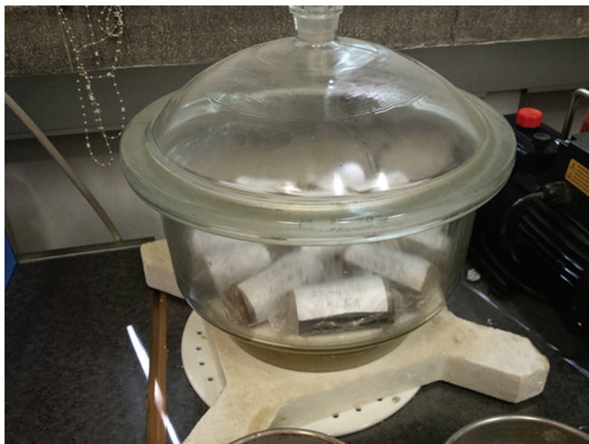
Slika 2. Čuvanje kompozitnih uzoraka u desikatoru i priprema za ispitivanje
