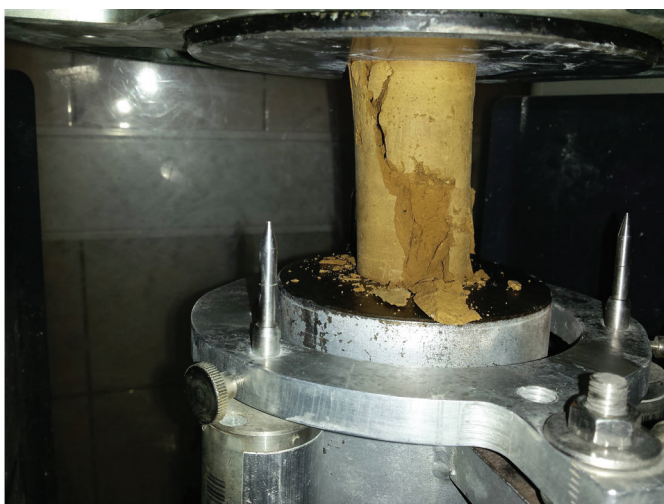
Slika 3. Ispitivanje tlačne čvrstoće kompozita u laboratoriju Zavoda za geotehniku Građevinskog fakulteta Sveučilišta u Zagrebu
