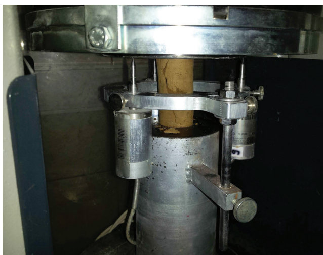
Slika 3. Ispitivanje tlačne čvrstoće kompozita u laboratoriju Zavoda za geotehniku Građevinskog fakulteta Sveučilišta u Zagrebu
