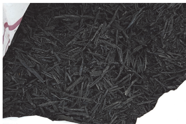
Slika 3. Reciklirani otpaci gume etilen propilen dienskog monomera - EPDM-a
