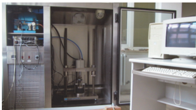
Slika 7. Ispitivanje rezilijentnog modula (Asphalt Tester)
