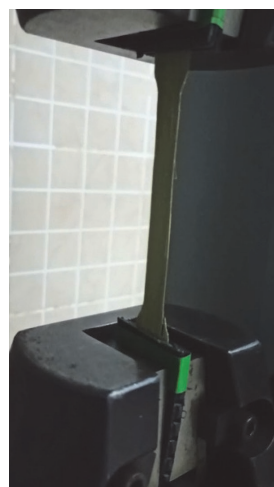
Slika 3. Fotografija uzorka PTPW-a tijekom vlačnog ispitivanja
