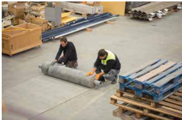
Vanjski omotač konstrukcije izrađen je od vodootpornih tankih betonskih ploča koje se mogu savijati
