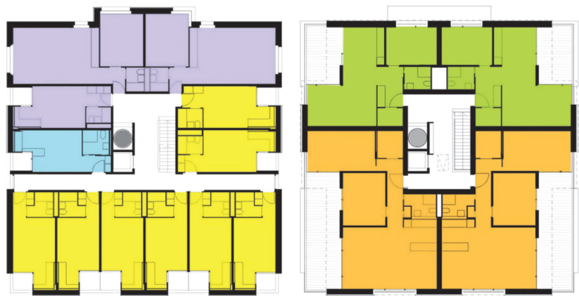
Slika 5. Tipični (lijevo) i potkrovlje (desno) tlocrti (1-sobni, 2-sobni, stanovi pristupačni invalidskim kolicima, 2,5-sobni, 3,5-sobni, ventilacijski otvor). Fotografija: Kämpfen für Architektur [24]
