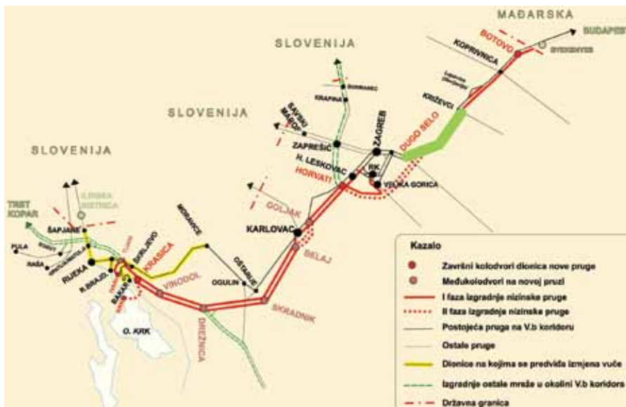
Projekt nizinske pruge Botovo – Zagreb – Rijeka s fazama izgradnje
