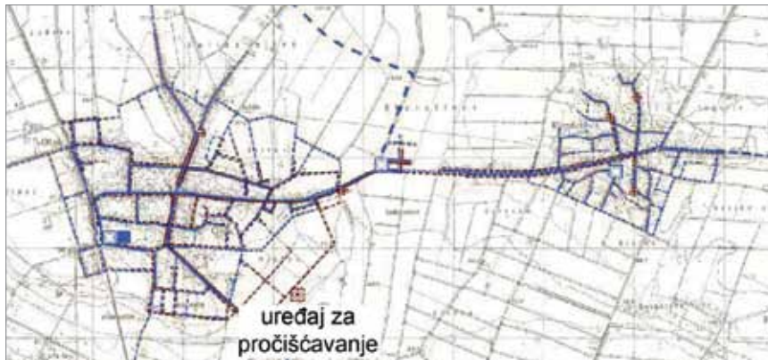
Sustav odvodnje otpadnih voda Otoka i Komletinaca
