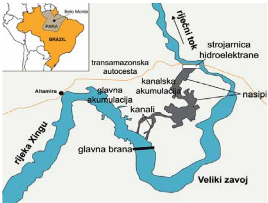
Shema akumulacijskih jezera, kanala i brana HE Belo Monte
