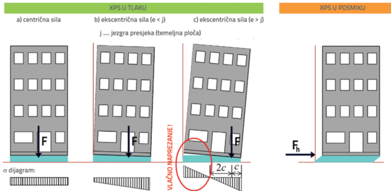
Slika 5. Ponašanje (krute) zgrade na fleksibilnoj podlozi (npr. toplinskoj izolaciji) ispod temeljne ploče
