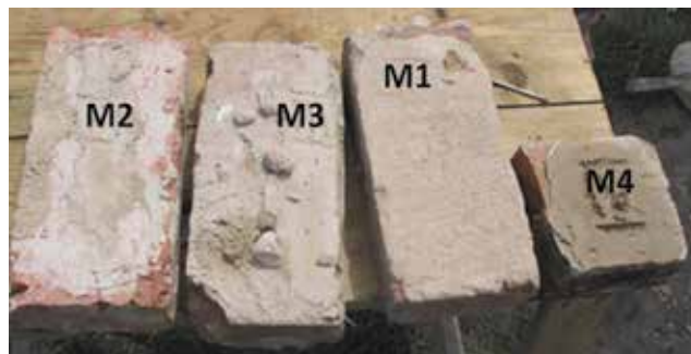
Slika 8. Ispitivanje ugradljivosti i konzistencije pripremljenih mortova
