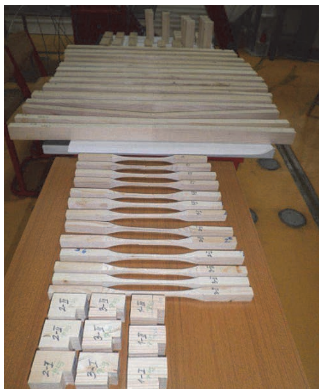
Slika 6. Pripremljeni mali uzorci za ispitivanje
