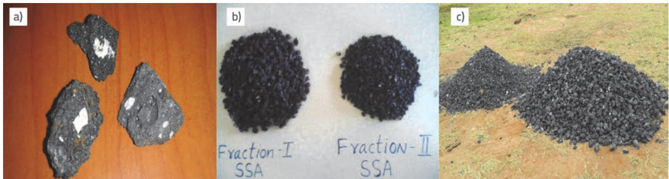
Slika 1. Čeličanska zgura kao agregat: a) sa slobodnim vapnom, hrapave površine; b) frakcije 1 i 2; c) na deponiji
