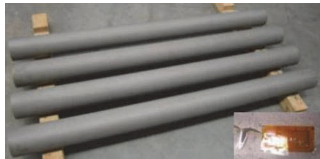
Slika 6. Pjeskarene čelične grede i uređaji za mjerenje
